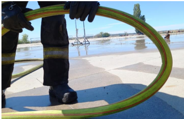
Figura 6. Manguera textil. Ángulo de giro cerrado sin colapsos. Fuente: CBCM
